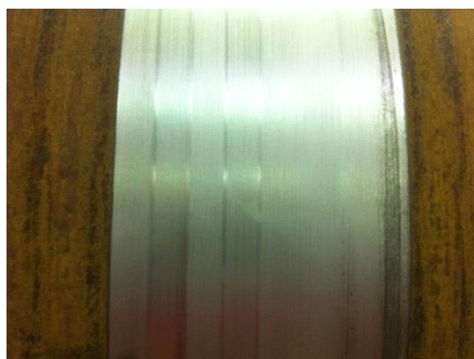
Рис. 4 Удаление сплошной коррозии с помощью лепестковых кругов
