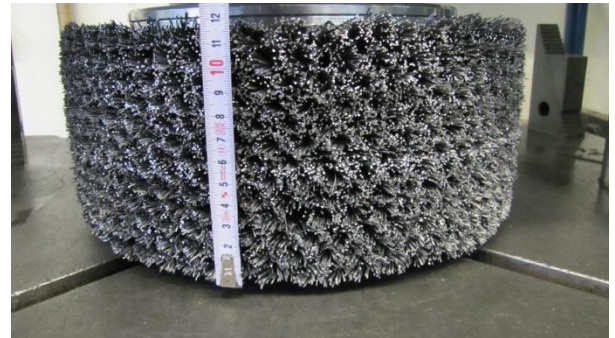
Рис. 6 Наборная корд-щетка с витым кордом.
