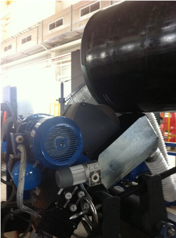
Рис. 6 Удаление полиэтиленовой изоляции на трубной базе ОАО «Сургутнефтегаз»
