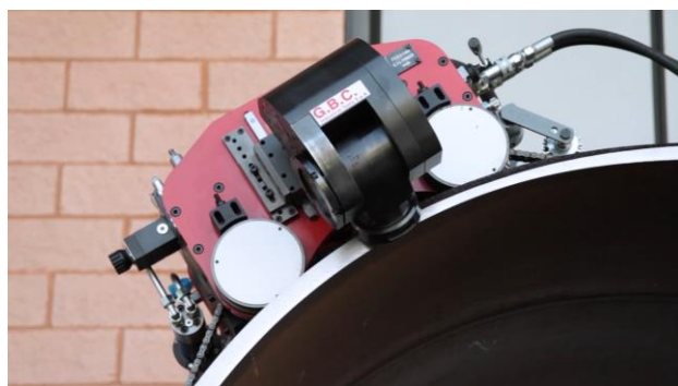
Рис. 4. TAF 120 при движении по трубе в режиме в режиме фрезерования кромки.
