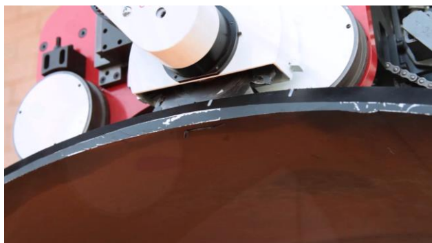
Рис. 3. TAF 120 при движении по трубе в режиме отрезания и выборки дефектов.
