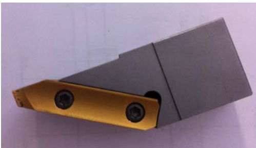
Комплект резцов комбинированных отрезных и кромочных для кромки 30 градусов первый и второй номер
