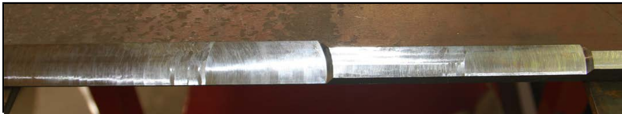
Рис. 3 Обработка листа толщиной 26 мм в три прохода.
