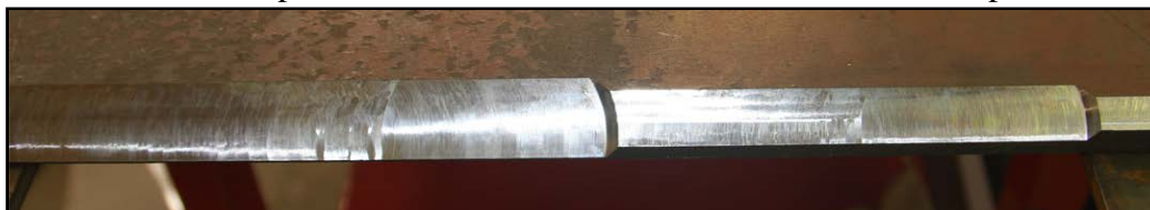
Рис. 3 Обработка листа толщиной 26 мм в три прохода.
