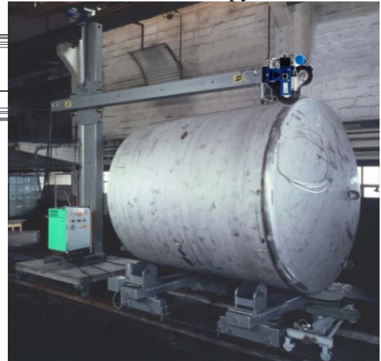
G 400 установленный на колонну.
